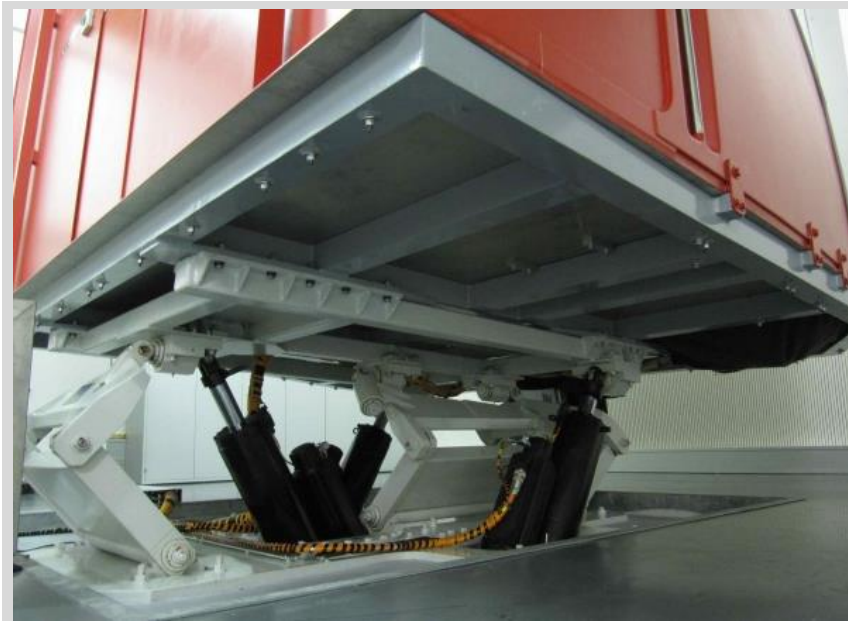
Abbildung 5: Bewegungssystem für einen Eisenbahn-Fahrsimulator mittels drei Aktuatoren und Gelenken, um die zwei Tonnen schwere Kabine zu bewegen. (SUTER 2013)
