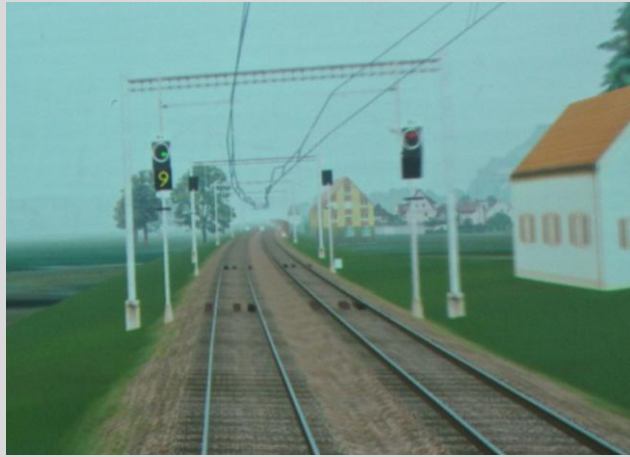
Abb. 3: V-Ausführung 90 km/h am Einfahrsignal von Aarau.
