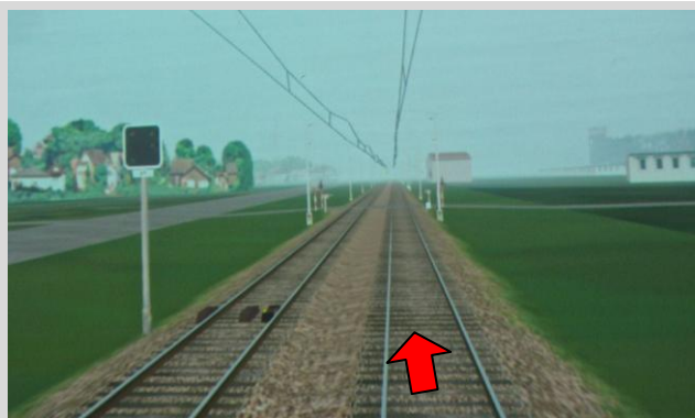
Abb. 7: Das Einfahrvorsignal Brugg ist dunkel (Störung). Im rechten Gleis fehlen die Streckengeräte für die Zugsicherung (Pfeil).
