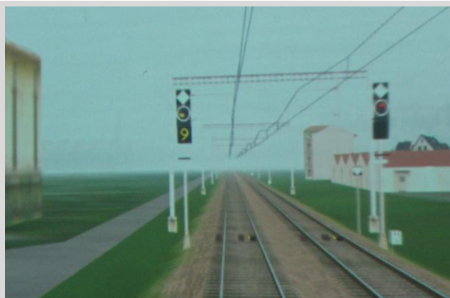
Abb. 2: V-Ankündigung 90 km/h am Einfahrsvorsignal von Aarau.
