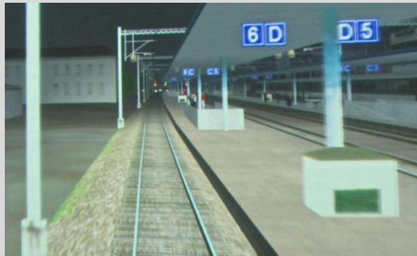
Abb. 14: Bei der Durchfahrt durch den Bahnhof Dietikon ist in der Ferne das Umschalten eines Signals zu beobachten. Es ist jedoch das Signal des Nachbargleises.
