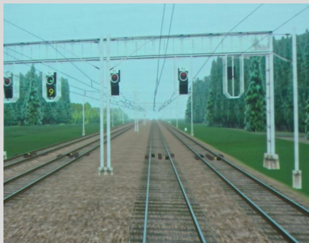
Abb. 5: Der Lokführer trifft ohne offensichtlichen Grund auf das Halt zeigende Einfahrsignal von Ruppertswil. Das Fahrt zeigende Signal links davon gilt für einen langsameren Güterzug, den er zuvor überholt hat.
