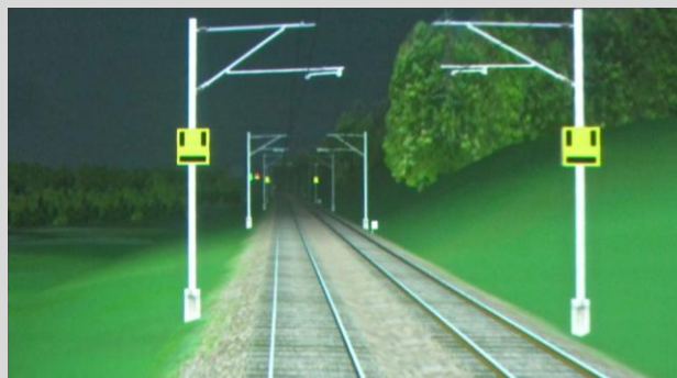
Abb. 11: Das Ausschaltsignal der Schutzstrecke folgt kurz nach dem Vorsignal für die Langsamfahrstelle 80 km/h. Der Ort der Schutzstrecke gehört zu den Streckenkenntnissen des Lokführers.
