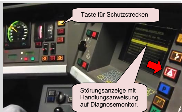
Abb. 9: Meldung der Fahrzeugstörung im Führerstand mittels Störungslampe (roter Pfeil) und Diagnosemonitor links davon.
