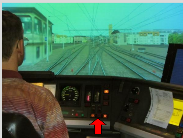
Abb. 4: Die Türkontrolllampe (Pfeil) muss vor der Abfahrt dunkel sein. Der Lokführer muss die Türen verriegeln, so dass die Türfreigabetasten (links und rechts vom Pfeil) nur noch schwach leuchten.
