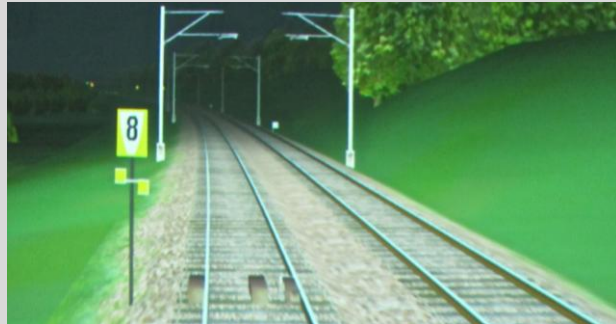
Abb. 10: Das Vorsignal für die Langsamfahrstelle mit 80 km/h taucht kurz nach der Triebfahrzeugstörung auf. Die Langsamfahrstelle wurde dem Lokführer bekannt gegeben (Verzeichnis).
