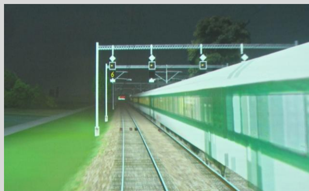
Abb. 15: V-Ankündigung 60 km/h zwischen Schlieren und Altstetten.
