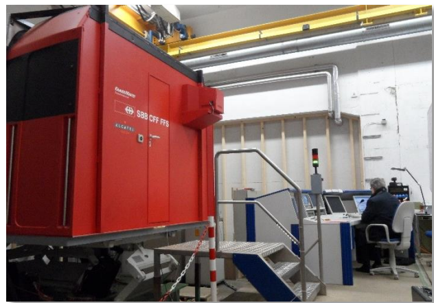
Abbildung 17. Fahrsimulator Re 460, Außenansicht mit Bedien- und Überwachungsanlage
