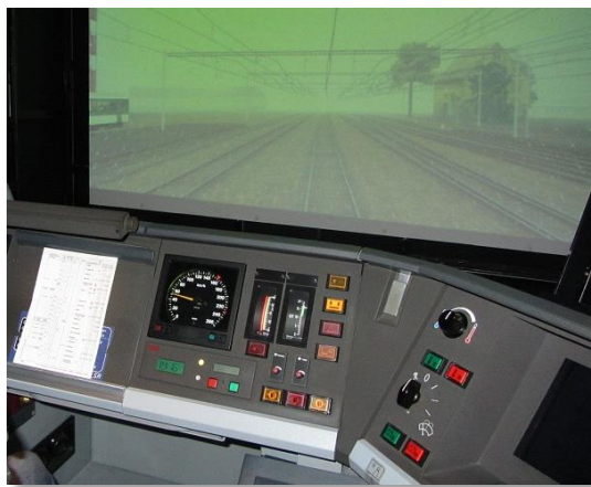
Abbildung 16. Fahrsimulator Re 460, Innenansicht
