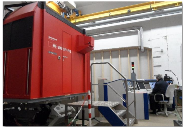
Abbildung 17. Fahr Simulator Re 460, Außenansicht mit Bedienungs- und Überwachungsanlage
