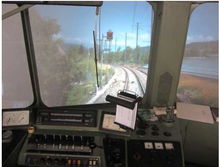
Der Lokführersand-Simulator vom Typ Re 4/4 im Forschungslabor auf der Strecke bei Langnau im Emmental.
