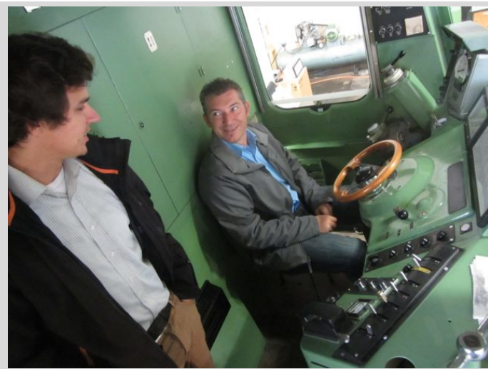
Abb. 7: Der Führerstand der Ae 6/6 ist restauriert und weitgehend ausgerüstet. Als nächster Arbeitsschritt steht der Einbau des Mikrocontrollers für die Verbindung mit der DESM-Middleware an.
