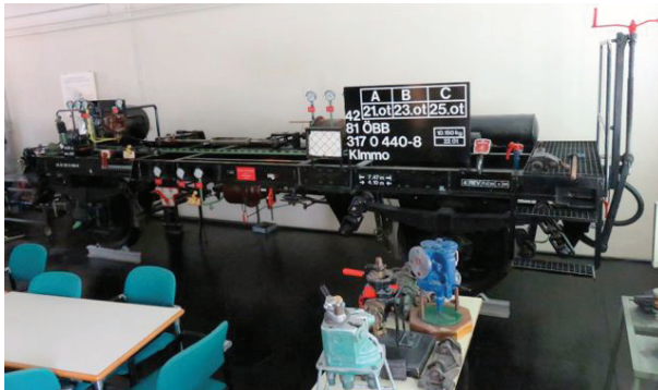
Ein Modell der Druckluftbremse eines Wagens im Bildungszentrum Wörth der ÖBB
