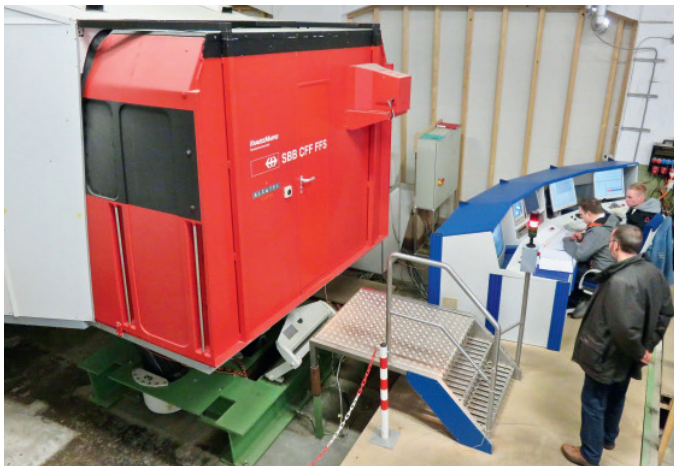
BILD 2: Der Fahr Simulator vom Typ Re 460 im DESM-Labor
