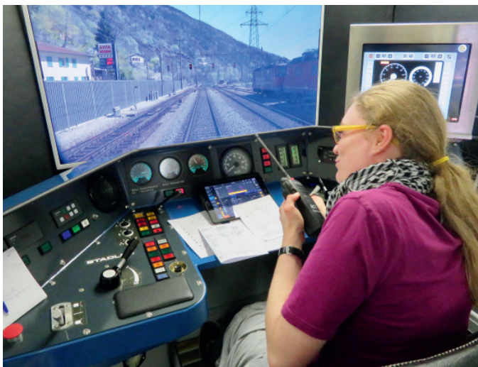
6 und 7: Im Simulator steht der Zug im Bahnhof Lavorgo vor dem Halt zeigenden Ausfahrtsignal. Die Lokführerin und die Fahrdienstleiterin stehen über Funk in Verbindung. Missverständnisse können Gefährdungen zur Folge haben Quelle: Jürg Suter
