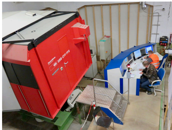
Abb. 5. Der Fahr Simulator der Schweizer Lokomotive vom Typ Re 460 wird heute für die Untersuchung komplexer Problemstellungen im Eisenbahnbetrieb eingesetzt.
