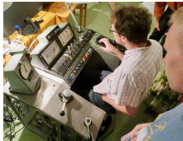
Test der programmierten SPS mit analogen und digitalen Signalen am Führerstand.
