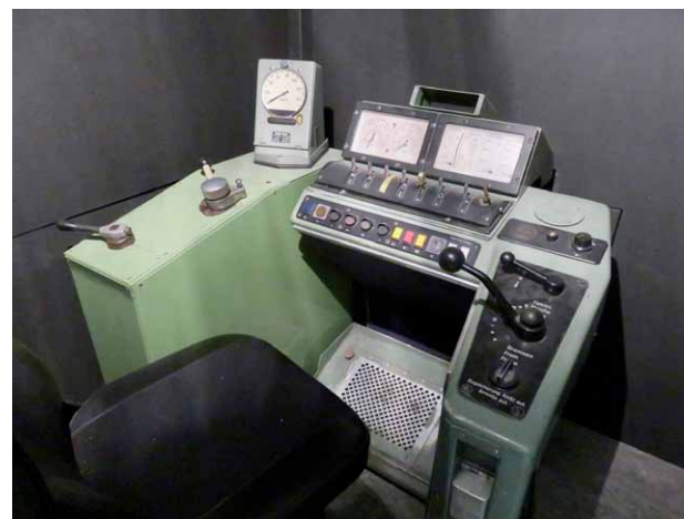
Versuchsweiser Einbau eines RBe 4/4-Führerstands in die neu angefertigte Kabine des zukünftigen Simulators.
