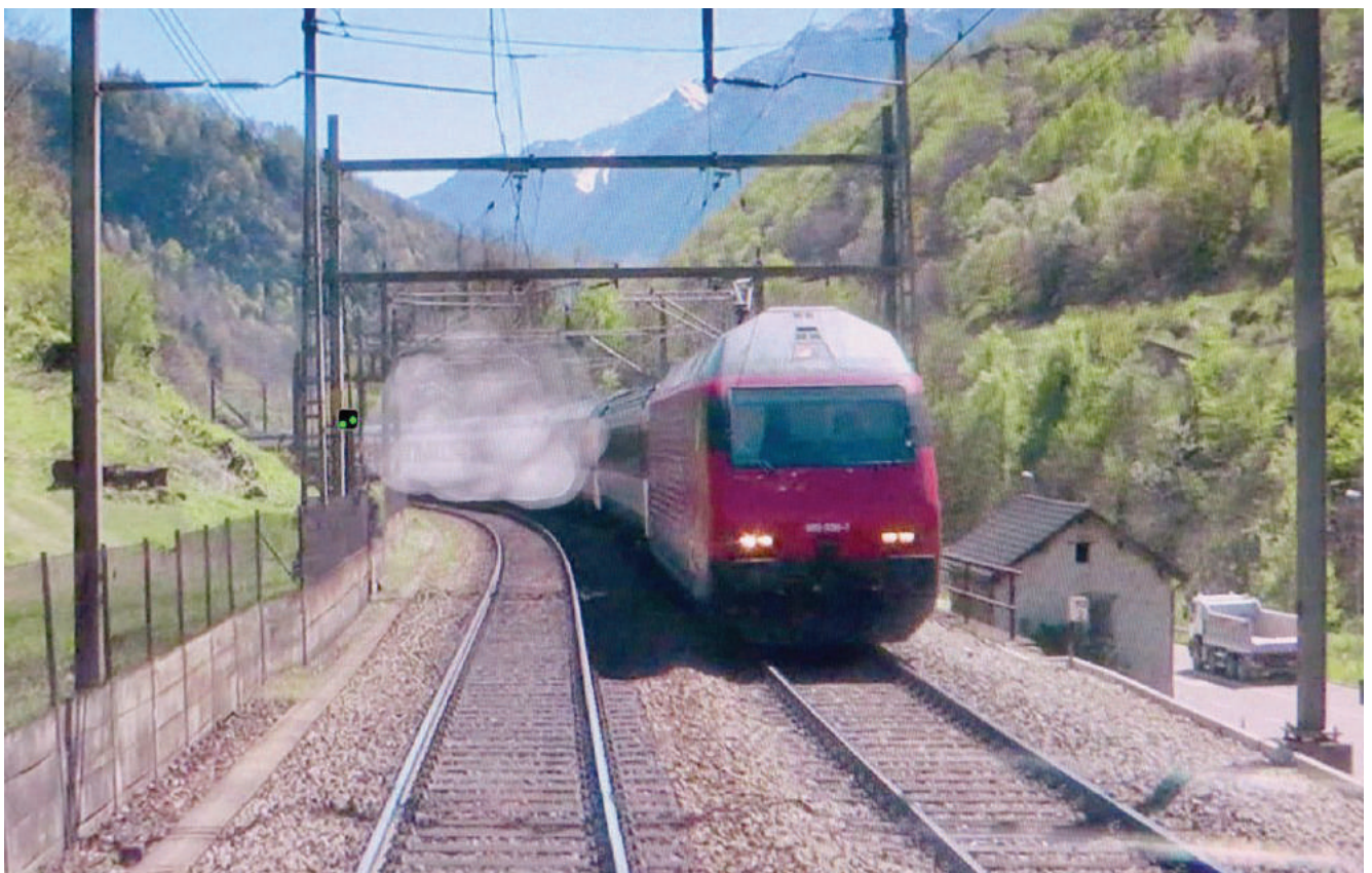
Der Simulator von LOCSIM funktioniert auf der Basis von Videoaufnahmen mit integrierten Animationen. Auf diese Weise können alle gewünschten Szenarien auf der Strecke Airolo - Biasca modelliert werden. Hier trifft der Lokführer auf ein Brandereignis, das dem Fahrdienst zu melden ist.
