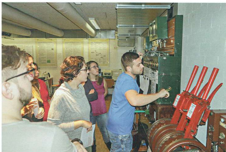
Elektrische Festlegung der Fahrstrasse am mechanischen Stellwerk im Betriebslabor der ETHZ (Foto: O. Knoll, 15. Januar 2020).
