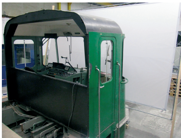
Der Re 4/4 II -Simulator und eine Leinwand für das Streckenbild. Mit der Distanz und der Neigung der Leinwand werden Versuche gemacht, um das optimale Raumgefühl zu erreichen.
