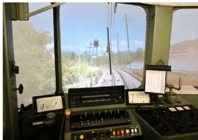
Die DESM-Re 4/4 mit dem videobasierten Ansatz der Locsim AG anlässlich früherer Versuche.
