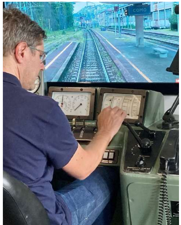
Björn Krebser bei der Instruktion auf dem LOCSIM-Simulator vom Typ Re 4/4.
