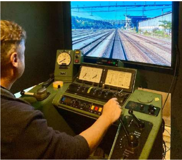
Test der Visualisierung mittels Monitors in der Kabine des Simulators RBe 4/4.
